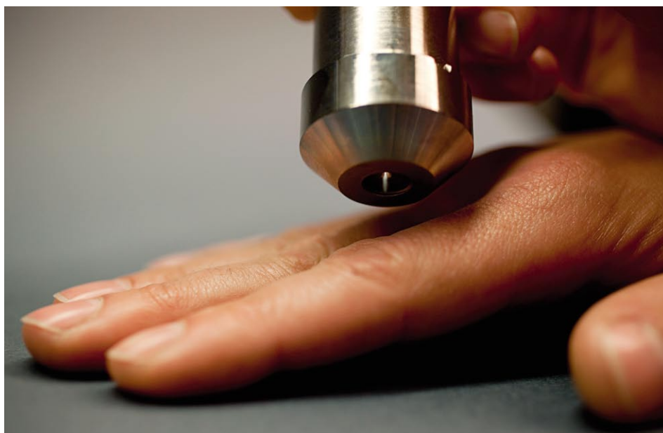
▲ Eine von vielen Anwendungen: Prototyp der Mikrowellenplasmaquelle bei der Hautbehandlung
